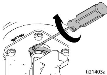
5. Установите и затяните гайку перегородки.
