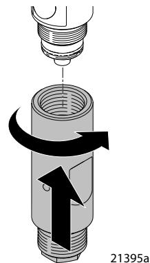
9. Установите блок распылительного наконечника/защитной насадки (G).
