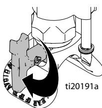
**Распылительный наконечник в переднем положении (положение РАСПЫЛЕНИЯ)**
