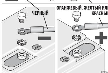
Для аккумулятора с выводом, имеющим резьбу
