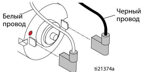
7. Установите кожух двигателя, зафиксируйте компенсатор натяжения проводов и затяните шесть винтов с шестигранным углублением под ключ.
